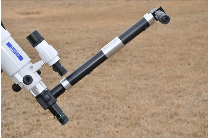
写真 11 2号機を市販の望遠鏡(ビクセン製)に取り付けた様子(2号機部分の拡大写真)
