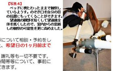
【写真4】ベッドに横たわったまま観察しているようす。のぞき口を自分の目の位置にもつてくることができます。望遠鏡の視野を広くして望遠鏡全体を低くしたので、窓からの窓差し光の観察の可能性を更に高めました。
