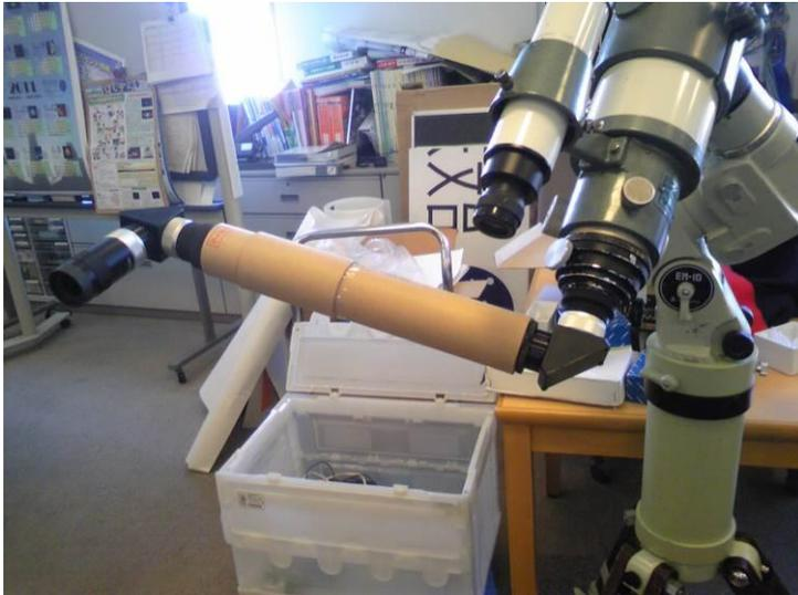
写真5 ユニバーサル天体望遠鏡の試作実験機
