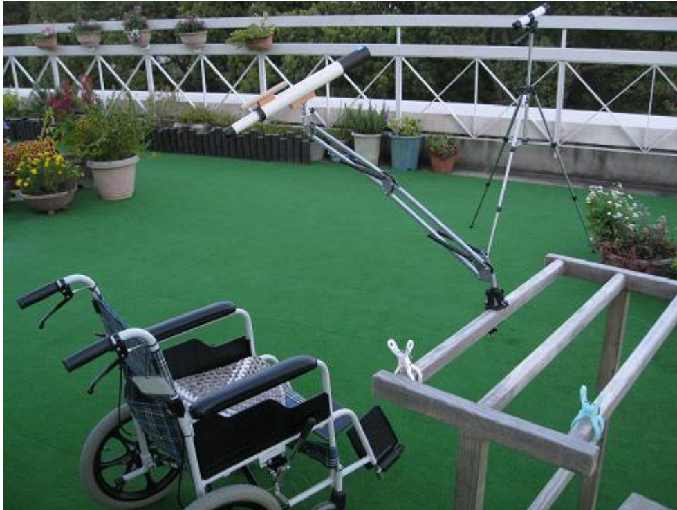
図1 木製フレーム(手ぬぐい干し)に装置全体を取り付けたところと車椅子を示す。長く伸びたアーム下部の空間が空いているので、車椅子は鑑賞することなく下部空間に入れる。
