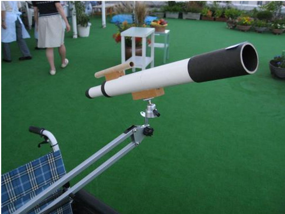
図2 電気スタンドの照明具部分を取り外し、卓上三脚の球面軸受け部をとりつけ、当該球面軸受けに軽量の望遠鏡を取り付けた。アーム先端部と取り付けられた望遠鏡の写真。
