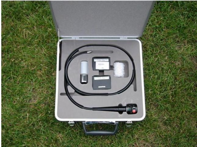
写真1: オリンパス光学製の工業用イメージングファイバー。ファイバー端面を望遠鏡接眼部に取り付けるアダプターは国立天文台先端技術センター製作。
