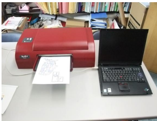
写真4 点字プリンターと、点字ソフトをインストールしたパソコン
