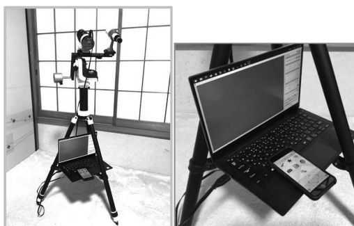
図 15 自動導入経緯台 AZ-GTi (36,800 円 Amazon 価格) 左: 装置全景 右: パソコンと架台制御スマホ
