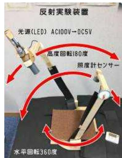
図7 反射実験装置（自作）
