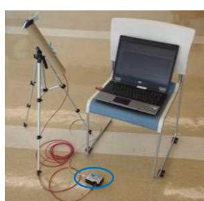
図 6 スペクトル観測のセット(丸印が分光器)
