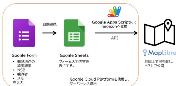
図2 地図へ自動反映する仕組み
