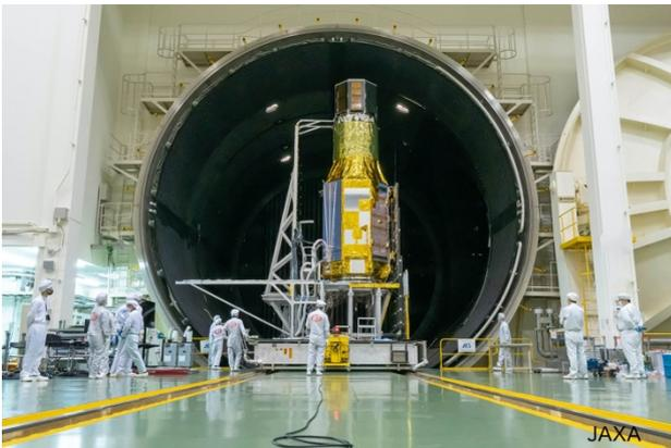
図1 XRISM衛星の衛星熱真空試験のため、直径13mの真空チャンバーに衛星を搬入する様子(クレジット: JAXA)。
