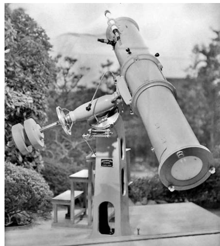
図9 当時アマチュアとしては最大級だった 26 cm 反射赤道儀[1]
