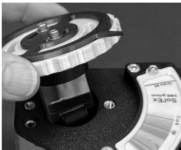
図 5 Sol' Ex で使用している反射型回折格子
