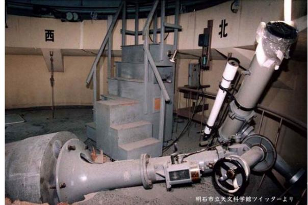
図 16 震災により倒壊した明石市立天文科学館のニコン 15cm 屈折望遠鏡[26]
