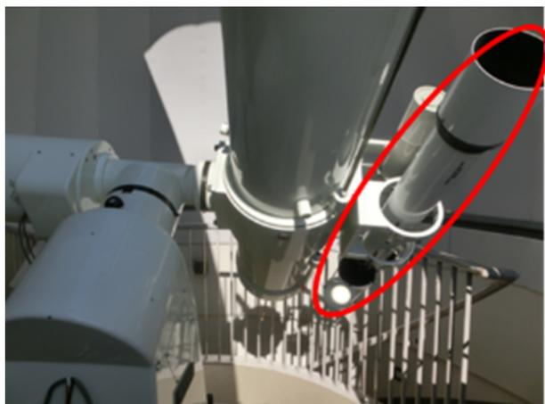
図4 使用した望遠鏡+太陽投影板（右端の丸印）
