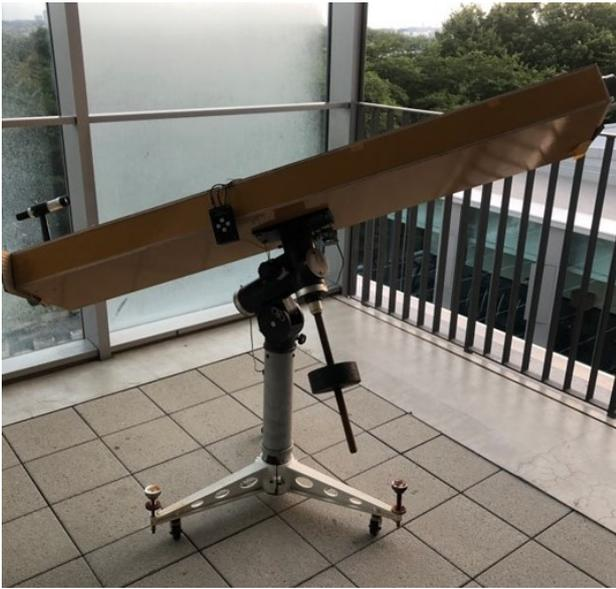
図8 試作した超長焦点ピンホールカメラ
