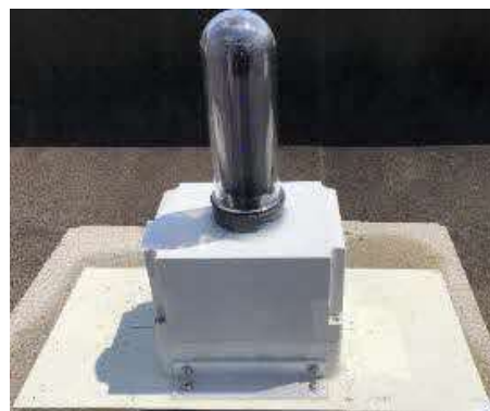
図1 全天球撮像装置とハウジング
