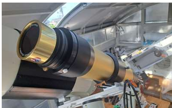
図2 ダブルスタックフィルター装着
