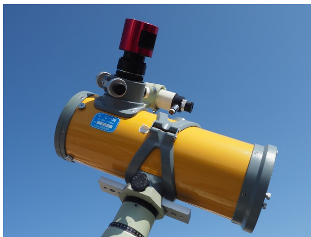
図 4 超新星を撮影した望遠鏡。タカハシ製 ε 130 に ZWO ASI178MCcooler をつけている。
