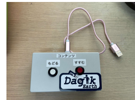
図4 ウェブ版ダジック・アースのためのコンテンツ順送りコントローラー
