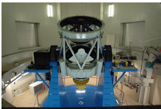
図2 西はりま天文台の2m なゆた望遠鏡 左側ナスミス台上の黒い箱が分光器。
