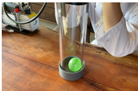
図7 アクリルパイプを使った減圧実験
