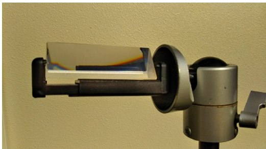
図2 スマホホルダーで三脚に取り付けたプリズム
