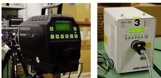
図5 分光放射輝度計 (左) と光源 (右)
