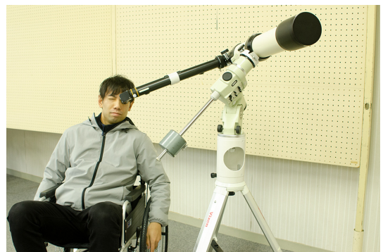
図1 ユニバーサル天体望遠鏡の使用例
