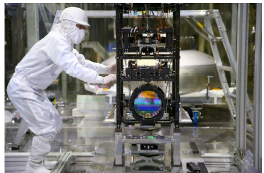
図 10 KAGRA の概略図 (上: 出典 東京大学宇宙線研究所) と防振装置に取り付け作業中のサファイア鏡 (下: 出典 東京大学)
