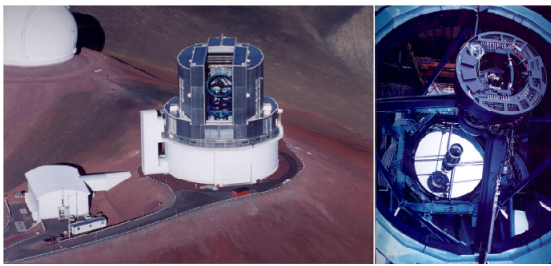
図 6 すばる望遠鏡（左）と主焦点に搭載された広視野カメラ Suprime-Cam（右）（画像提供：国立天文台）
