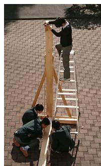
図3 横梁の真下の点を求める
