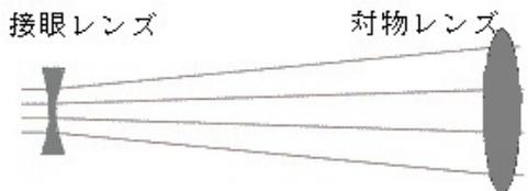
図4 ガリレオ式望遠鏡の構造
