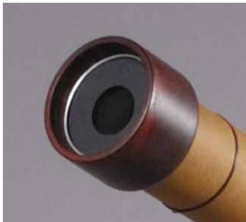
図7 ガリレオ作 倍率14倍望遠鏡レプリカ 対物レンズ(外径51mm)を有効径26mmの「絞り」で覆っている。
