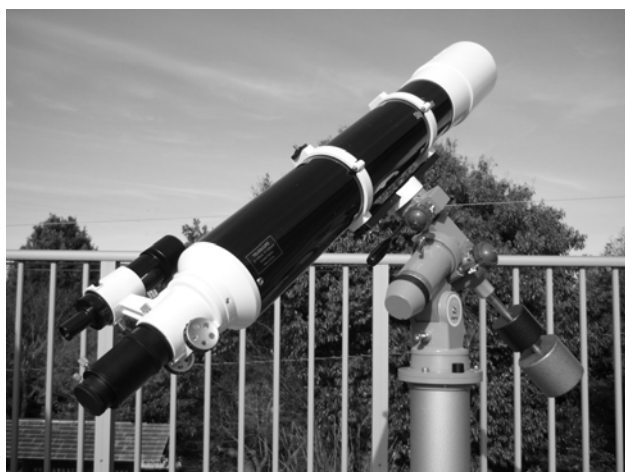
図 2 実験に用いた口径 15cm、焦点距離 120cm の安価なアクロマート屈折望遠鏡
