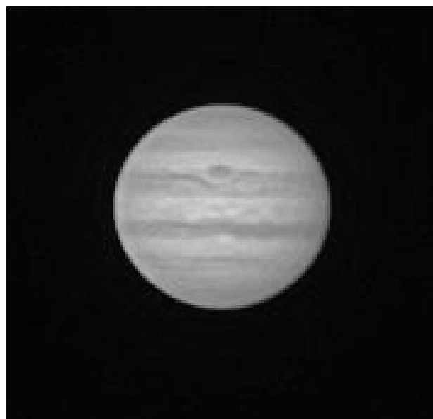
図8 比較のためにカラーCCDカメラで撮像した木星画像。強烈な色収差によりぼやけた画像となっている。
