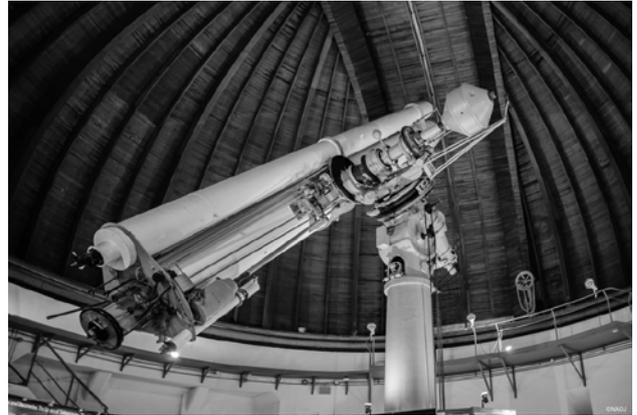
図1 65cm 屈折望遠鏡[4]
