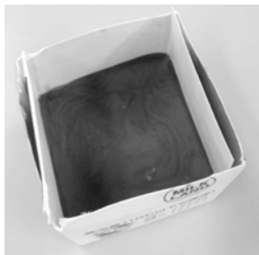
図3 石膏を流し込んだ状態
