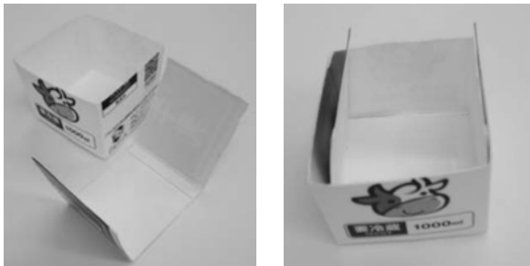
図2 牛乳パックで作る石膏流し込み部
