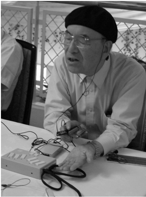
図2 体表点字をデモンストレーションしている場面。体表点字は体のどこを使って読み取ってもよいが、ここでは、振動子を耳にかけている。
