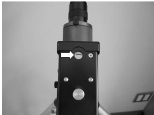
図 6 LHIRES Lite のスリット面（矢印）スリット面は鏡のようになっている。
