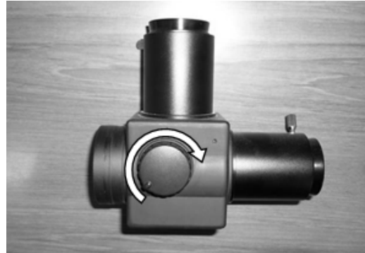
図 5 株式会社ピクセンのフリップミラーつまみの部分を回転させて、切りかえ板の角度を変える。
