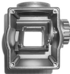
図7 フリップミラーの光路切りかえ板に穴をあけ、その上に透明ガラス板を接着した
