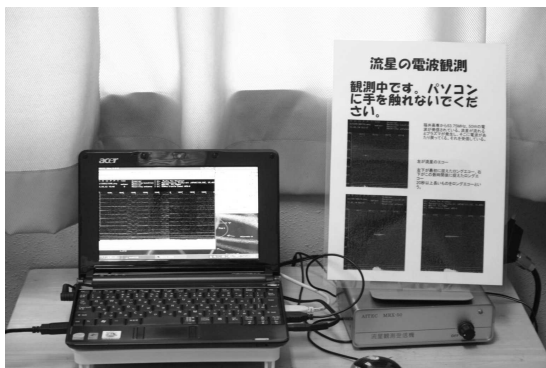
図3 流星電波の観測装置
