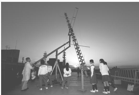
図 1 水戸二高地学部の製作した 20m 空気望遠鏡
