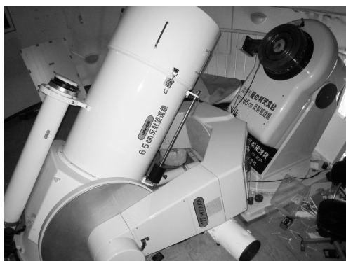
図3 星の村天文台 65cm 反射望遠鏡の被害状況。フォーク式赤道儀の赤経部分から破損し、脱落した望遠鏡。（写真提供：大野裕明氏）
