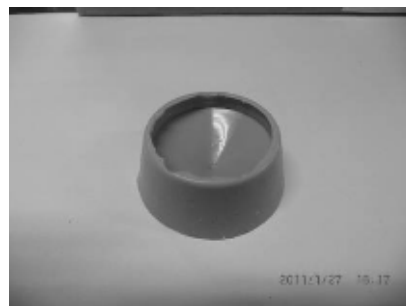
図4 できあがったシリコーンゴムによる円錐レンズの型
