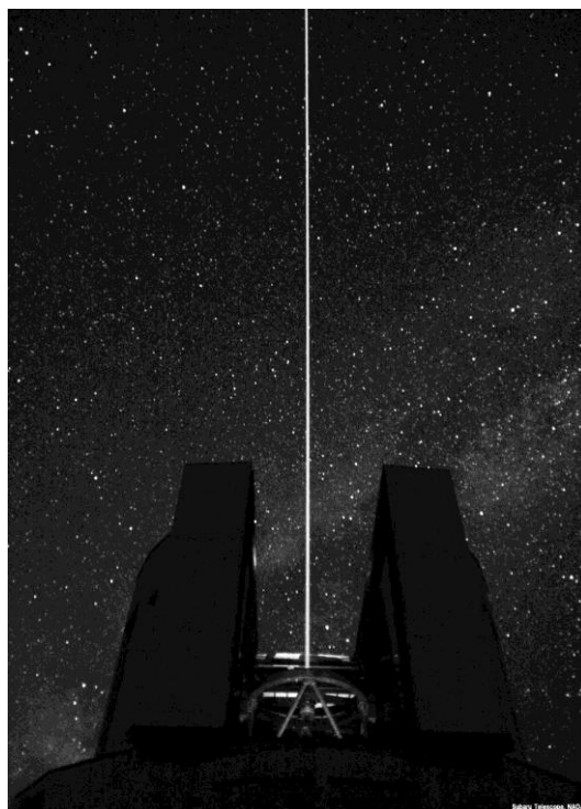
図 13 すばる望遠鏡から、レーザーガイド星・生成用レーザービームを初照射 (2006 年 10 月)。(Credit: 国立天文台)
