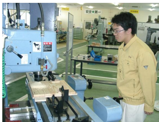
図2 曲線カットにはNC工作機械を利用
