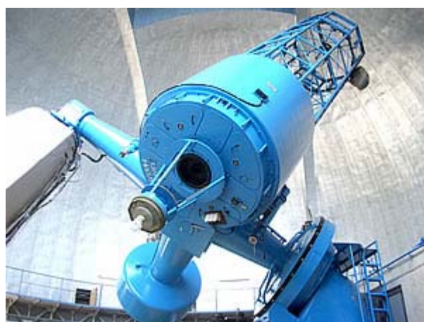
図14 岡山天体物理観測所74インチ反射望遠鏡[28]。極軸の南側（写真では右）にクーデ分光器室があった。現在は、HIDESというエッセル分光器がおかれて活躍している。
