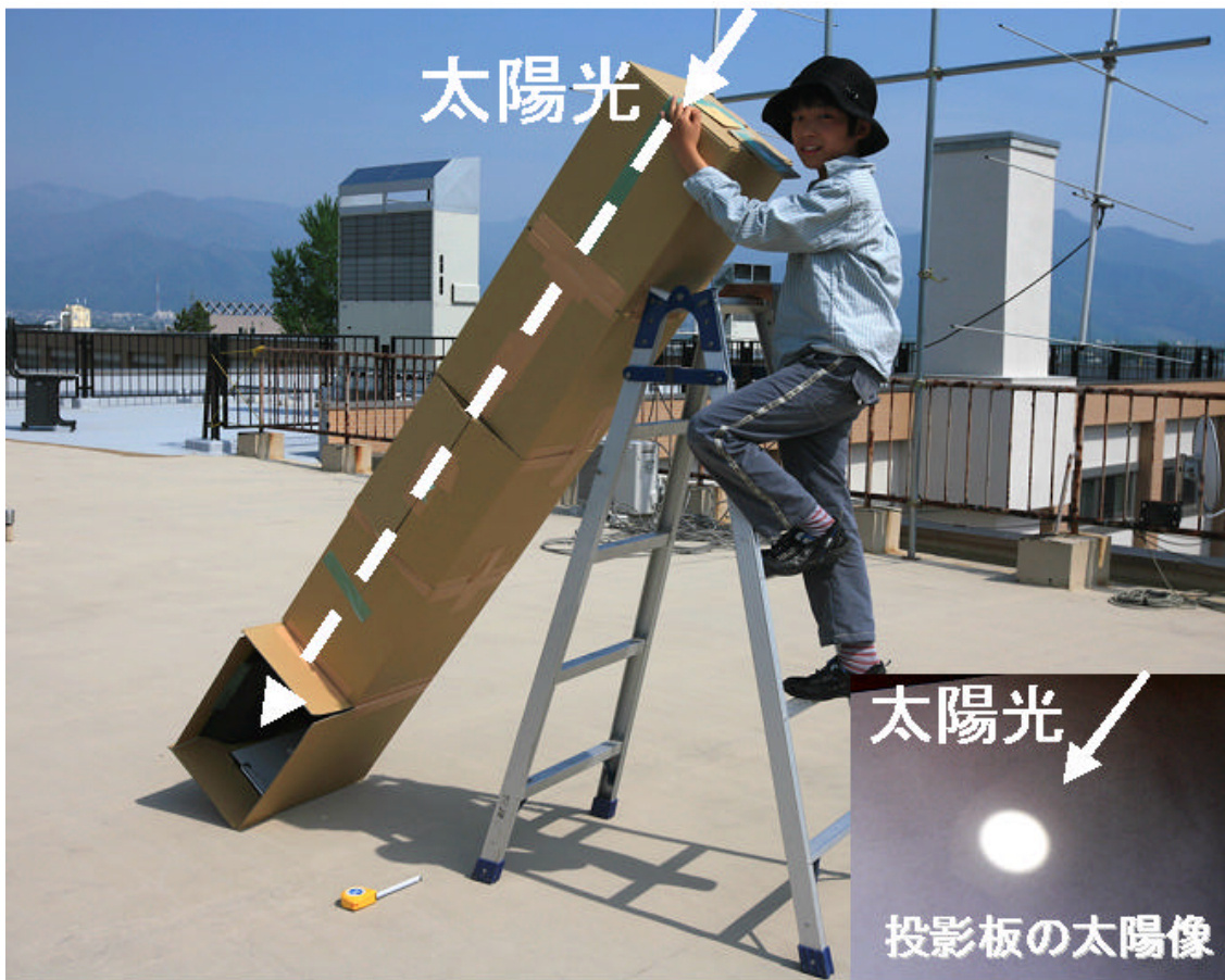
図4 段ボール箱連結型投影机と投影板に写った太陽像。脚立を台として、太陽方向に調節をする
