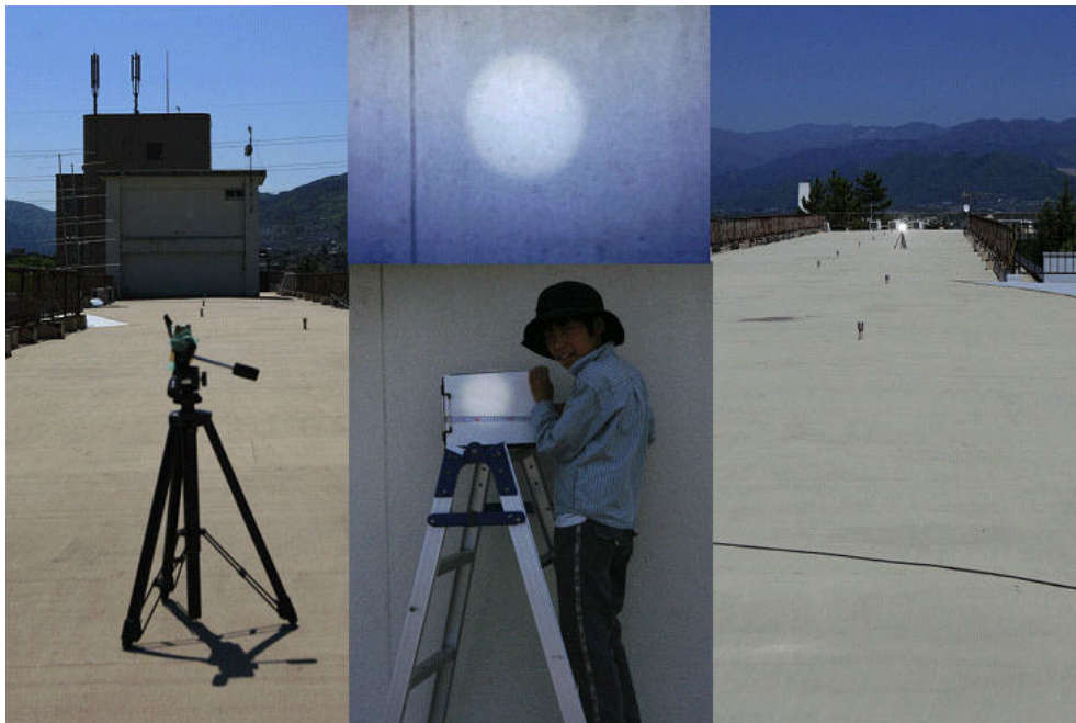
図5 ビルの壁に映した太陽像、(左)鏡をビルの壁に向けた様子、(中央上)壁に映った太陽像、(中央下)測定中(右)鏡が反射している様子
