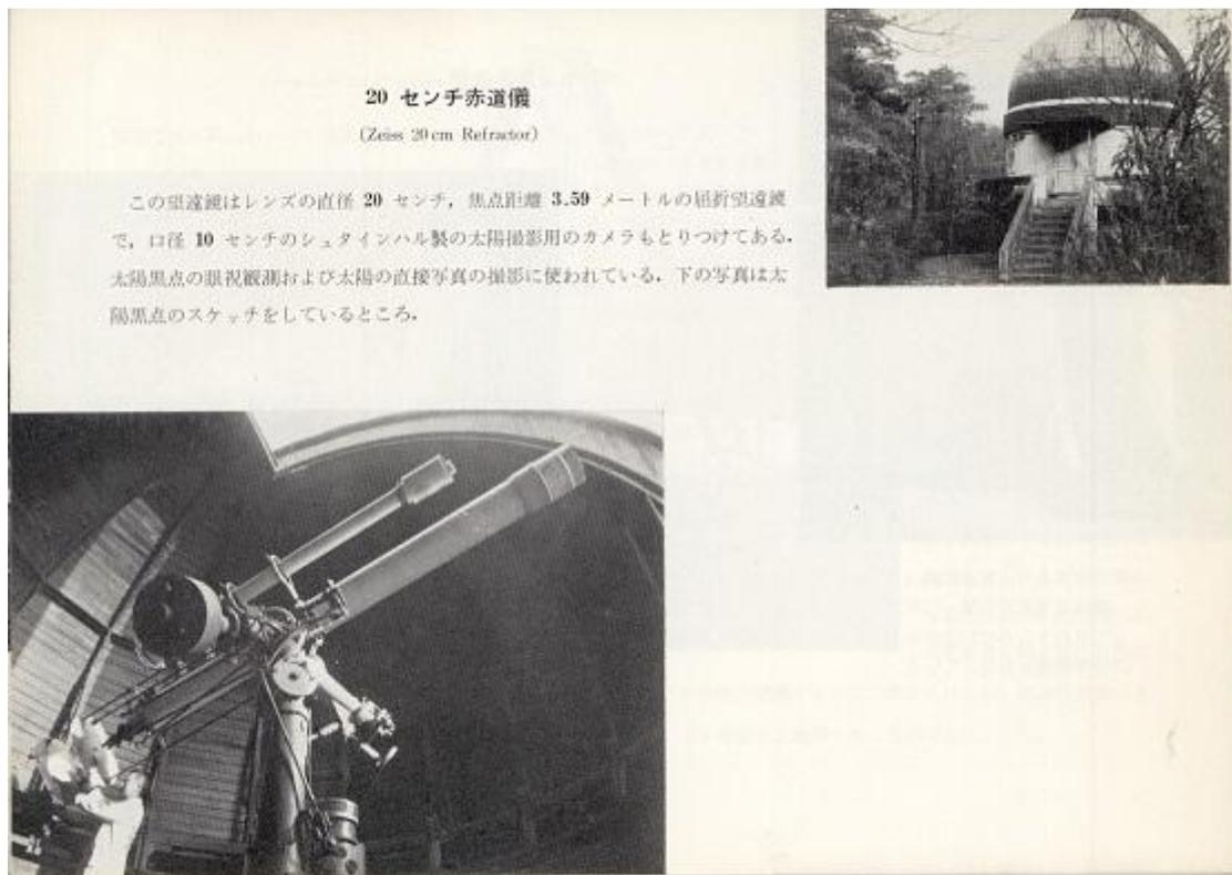
写真 5 太陽黒点スケッチ観測に使われた 20cm 屈折望遠鏡
