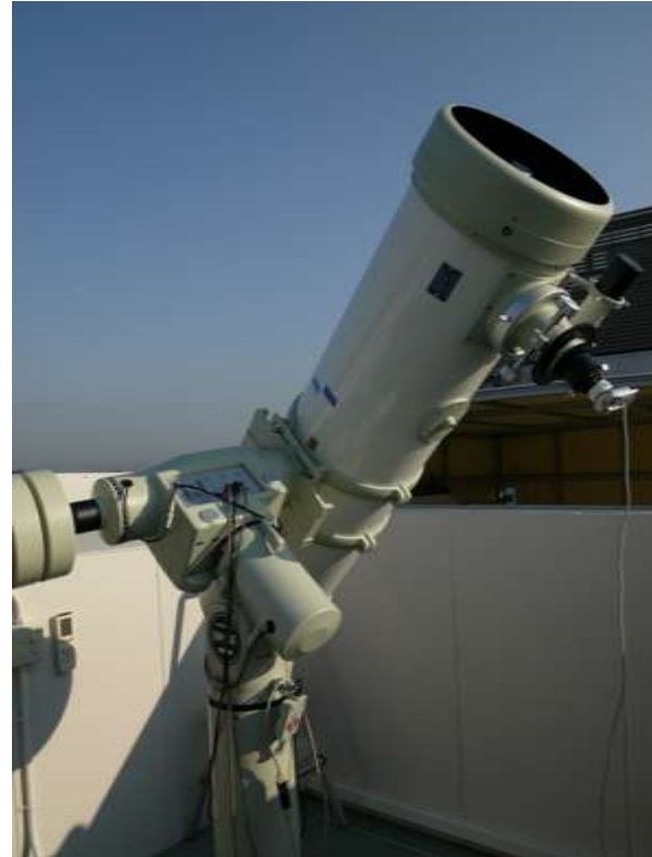
30cm反射望遠鏡 タカハシ製 焦点距離 1500mm
