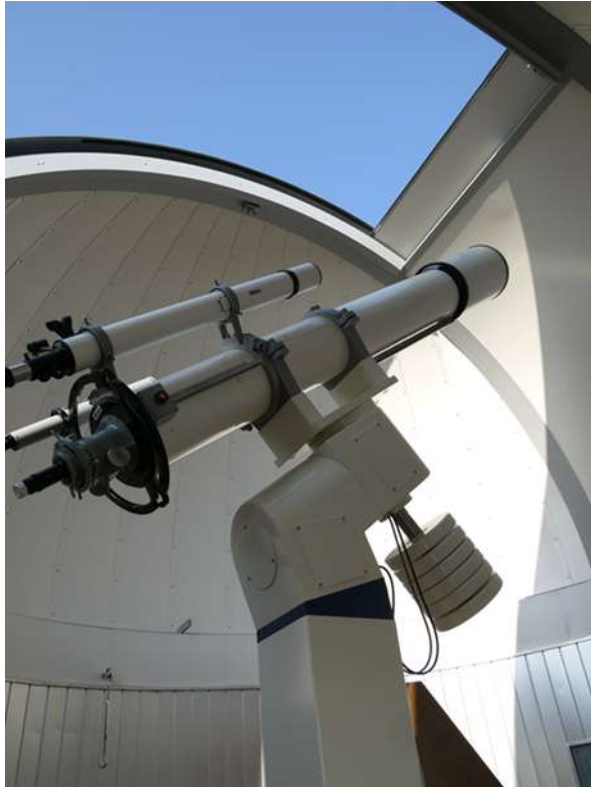
20cm屈折望遠鏡 ニコン製 焦点距離 2400mm
