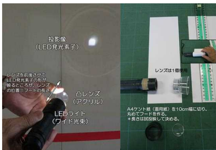
図6 凸レンズでの光束実験
