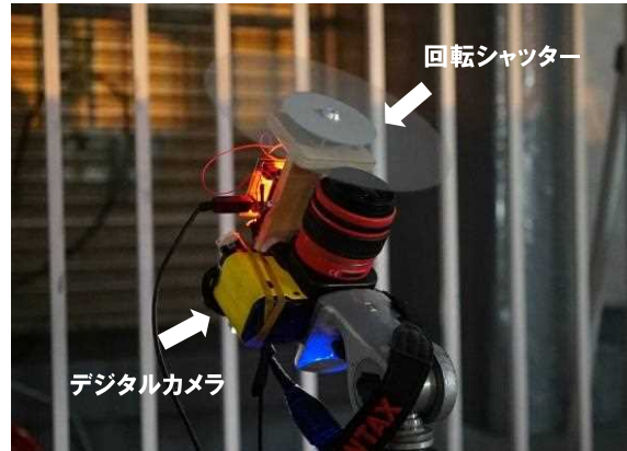
図 2 量産した回転シャッター 回転シャッターはカメラ上部のアクセサリシュー ーに固定されレンズに影を作り流星像を切断する。
