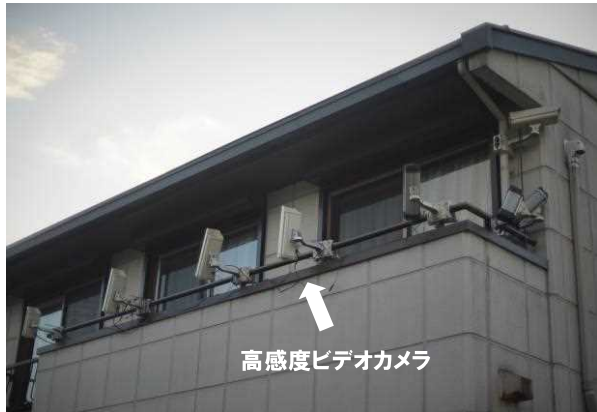
図 1 高感度ビデオによる流星監視例 ハウジングの中に高感度カメラが入っている。 屋内にビデオ線を引き込み、PC で捉える。
