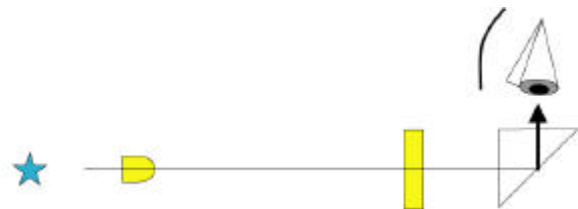
図2 光学系の光路図 左から夜空、発光ダイオード、黄色フィルター、 天頂ミラー
