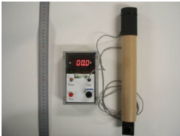
図1 夜空メーター 中央が本体部、右側が光学系
