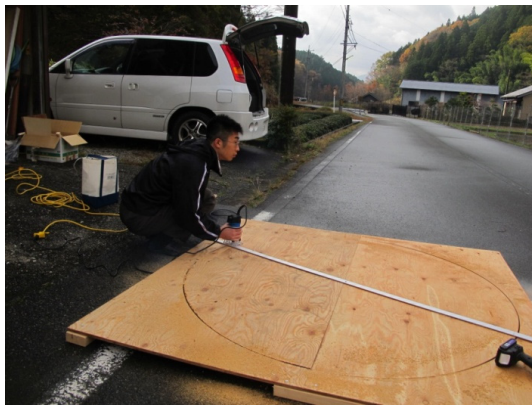
図6 トリマで合板を切断している様子
