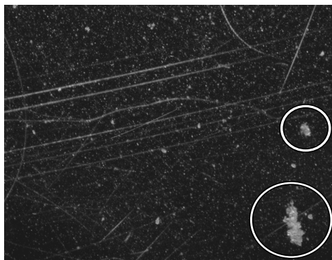
図 7 太陽観察フィルタシート表面の顕微鏡画像(50倍)
