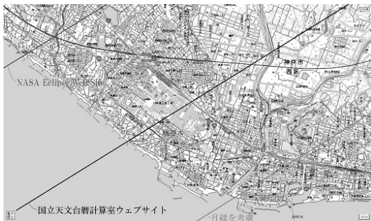
図1 金環日食北限界線の位置の予報(明石付近)。西(左斜め上)よりNASA Eclipse Web Siteの予報の限界線、中央が国立天文台暦計算室の予報の限界線。両者は約2.7km離れている。東(右下)は月縁を考慮した相馬一早水の予報の限界線。国土地理院の電子国土Webシステム提供のデータより制作。
