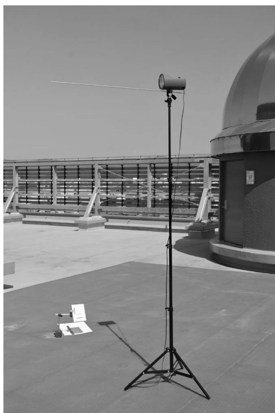
図 6 圭表を模した装置での観測実験風景 表の高さは 8 尺（約 2.4m）程度。
