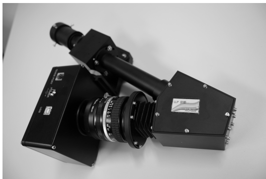
図1 LLP 京都虹光房が開発、製造した可視光分光器（KNK-0004A）
