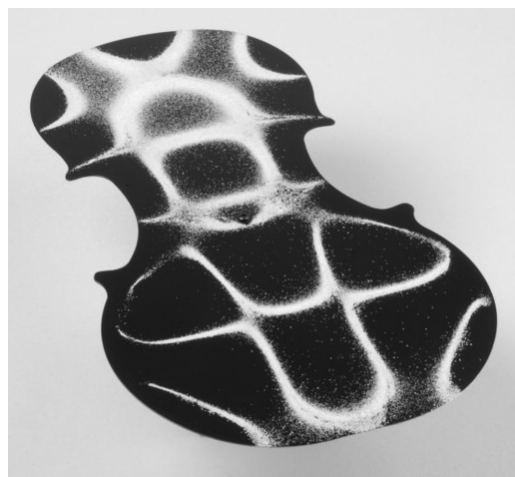
図 58 ヴァイオリンのクラドニ図形
