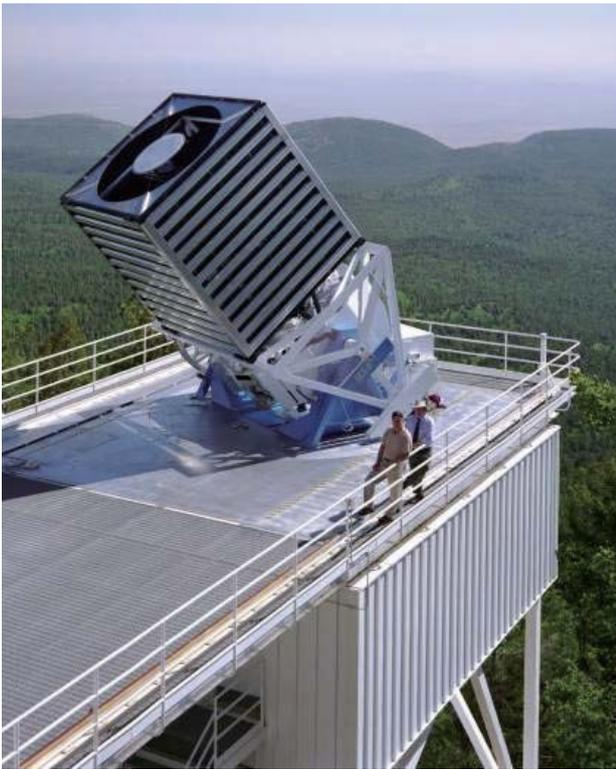
図 22 SDSS プロジェクトのためにアパッチ・ポイント天文台に作られた口径 2.5m の専用望遠鏡
